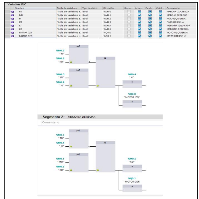
Fig.6 Programa en lenguaje FUP (diagrama de funciones) para el PLC.
