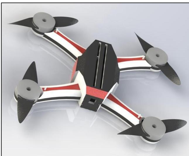
Fig. 19 Renderizado Final del Ensamble.
