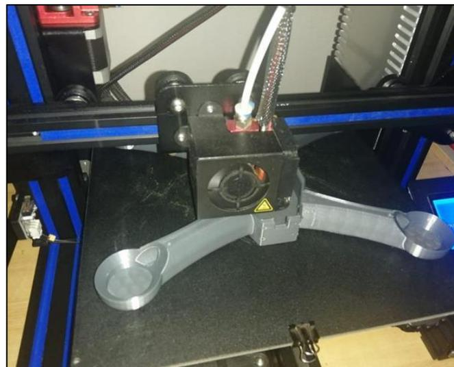
Fig. 21 Manufactura de la Base del Cuadricóptero en la impresora Ender 3.
