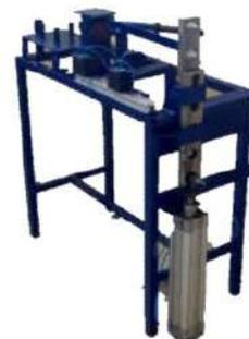
Hablamos de un prototipo con características similares a las profesionales. Con esta propuesta se logró el óptimo funcionamiento del prototipo realizando cortes de material de uso rudo a una presión de 160 Psi, siendo esto un resultado satisfactorio para el equipo que lo construyó. Además se pudieron resolver las fallas técnicas que surgieron después de realizar el ensamble de todos los componentes.
